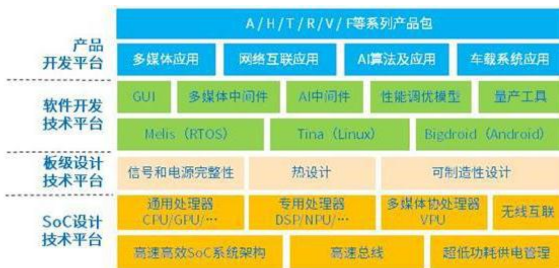
图表 1: SoC 产品包的基础架构示意图
