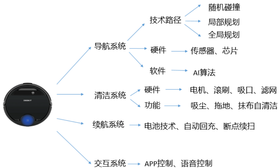
图表 3：扫地机器人系统构成
