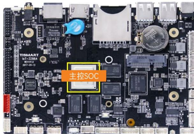
图 54: 商业显示主板拆分: 主控 SOC 为核心
