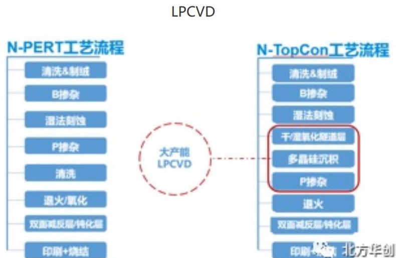
图：LPCVD在TopCon工艺的应用
