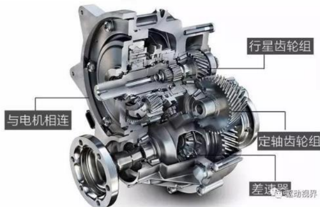
图 15：舍弗勒两档减速器示例
