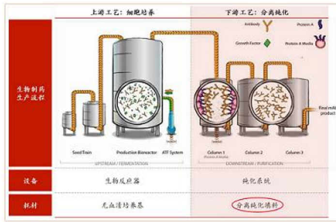
图 21：生物药生产流程示意图
