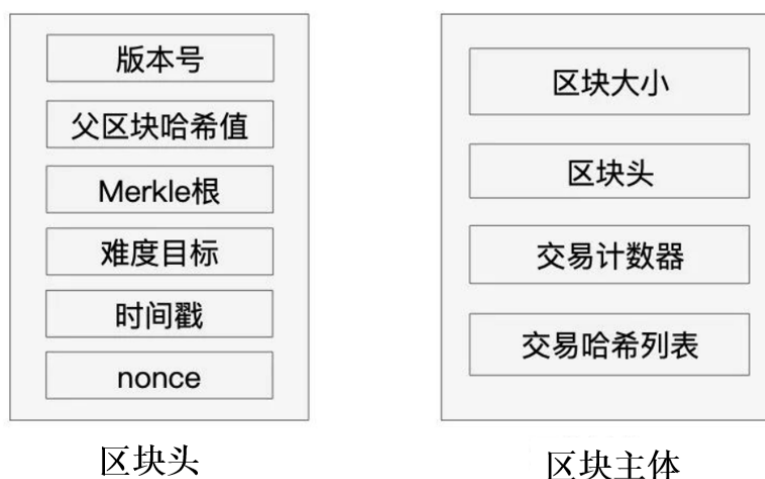
图1：区块链数据结构包含区块头和区块主体
