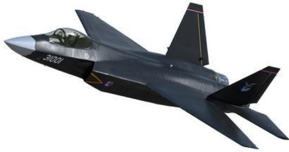
图 30: FC-31 外倾双垂尾、全动平尾的正常式布局
