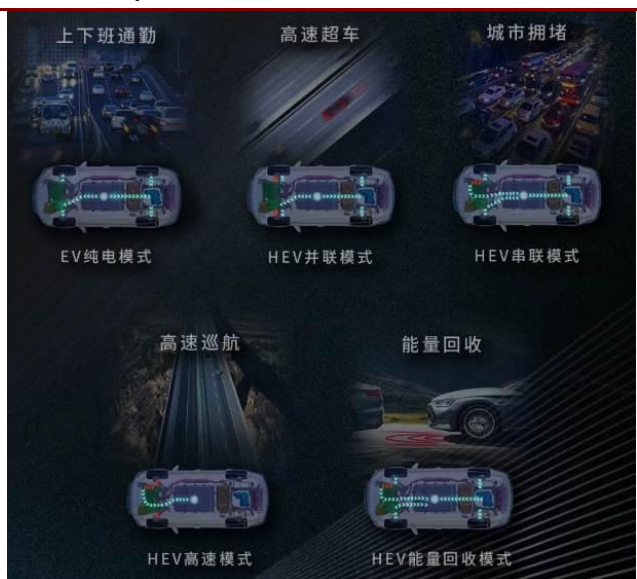
图 42: DM-p 的五种动力模式
