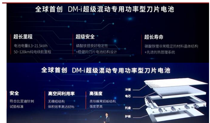
图 50: DM-i 专用功率型刀片电池具备超长里程、安全性高
