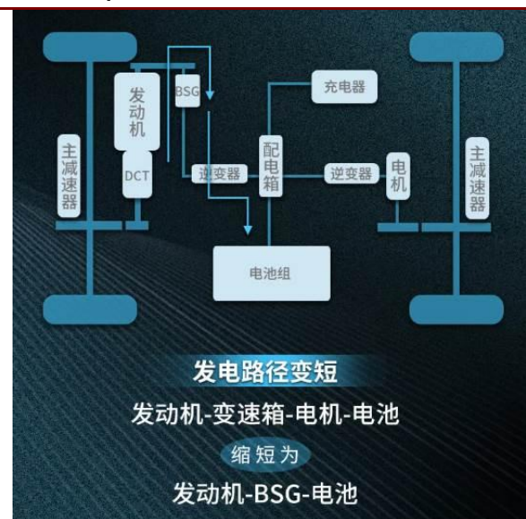
图 43: DM-p 的双擎四驱（P0+P4）系统架构
