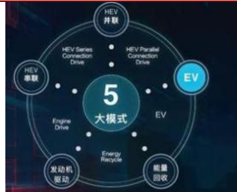
图 38: DM III 拥有五种工作状态
