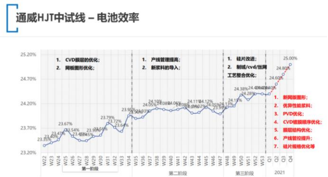
图 6：通威合肥 HJT 中试线转换效率达 24.3%
