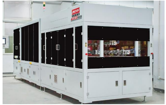
图16: 金辰股份研发的自动双轨串焊机
