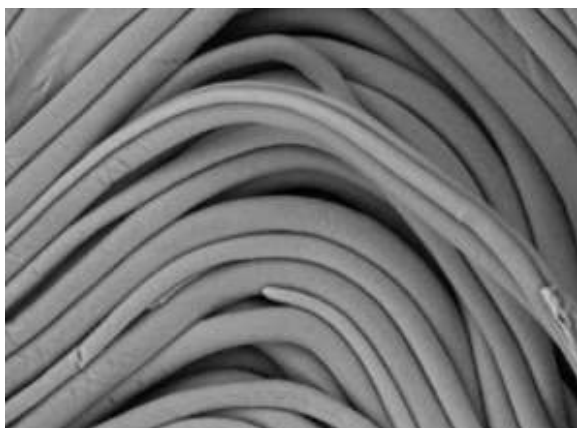
图 9：新鲜棉花的扫描电镜图
