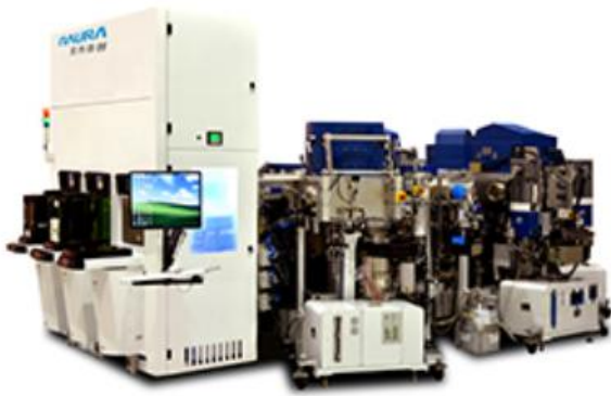
图表 30: 北方华创 PVD 机台 eVictor AX30 AI pad PVD
