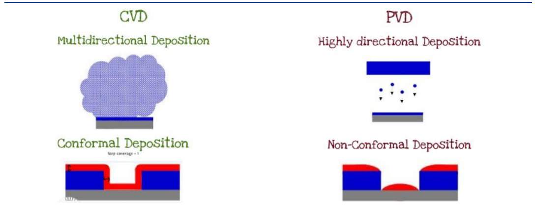
图表 7: CVD 和 PVD 技术比较示意图
