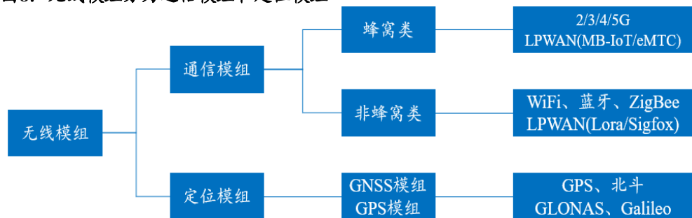
图8: 无线模组分为通信模组和定位模组
