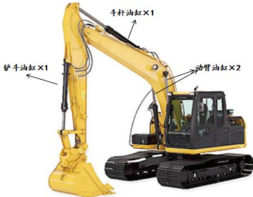
图 43：挖掘机油缸示意，单台挖机配 4 根油缸
