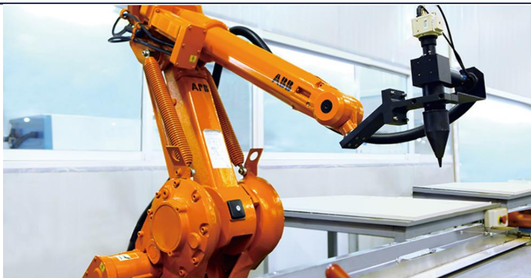
图表 18 美大生产线上的 ABB 激光焊接机器人
