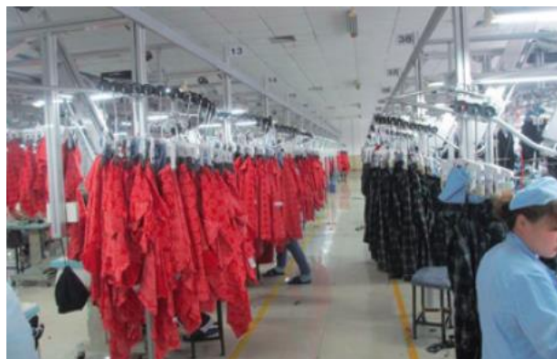
图 47：公司精益生产——智能吊挂系统
