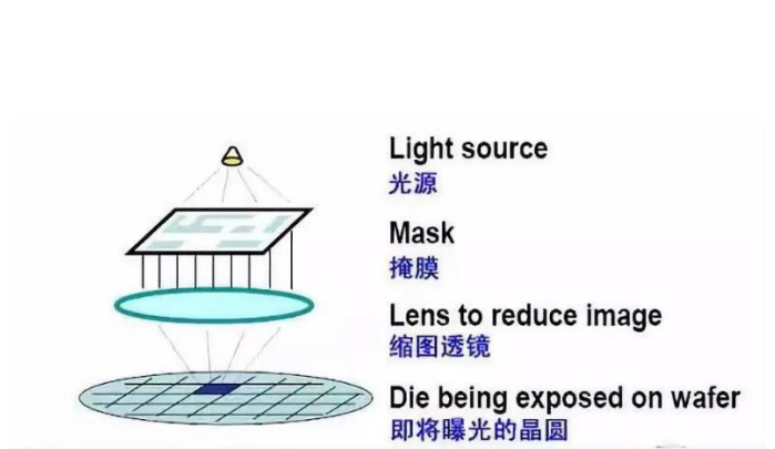
图表 49 光刻机光源原理示意图
