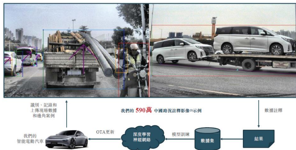
图表8 小鹏汽车 XPILOT 闭环数据处理过程
