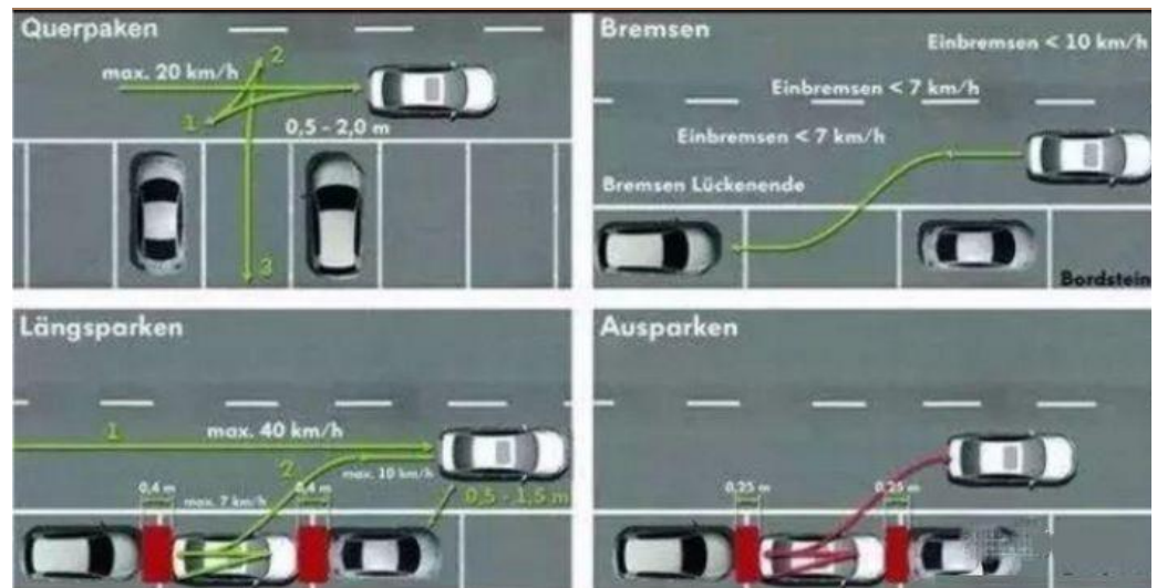
图 2：自动泊车系统原理
