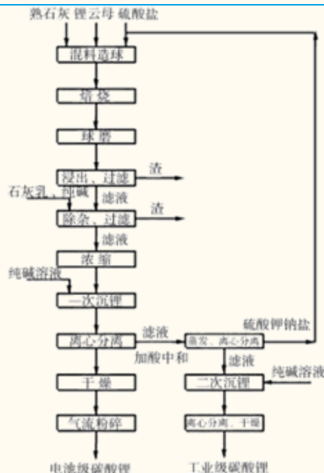
图表 15：锂云母硫酸盐焙烧法生产碳酸锂的工艺流程图
