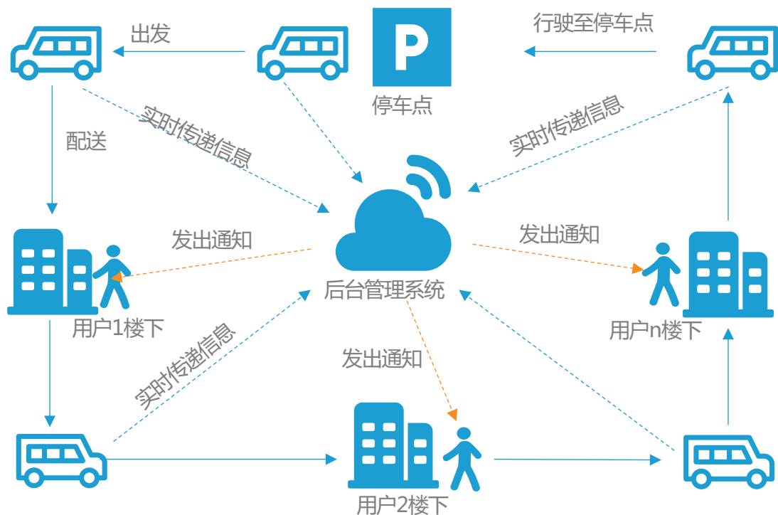
亿欧智库：自动驾驶末端配送小车在封闭小区的应用模式
