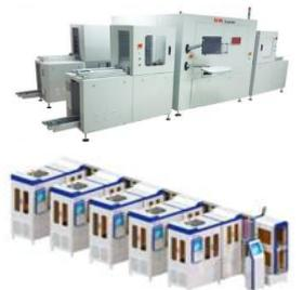
**MWT 系列激光设备** 光伏电池片/组件 该设备在硅片、封装材料表面打高精度孔洞、在铜箔材料表面刻划线路，孔洞把太阳能电池的正面板转移至背面线路，减少正面遮光面积，提升电池效率。高精度激光打孔、刻划技术是 MWT 核心工艺。
