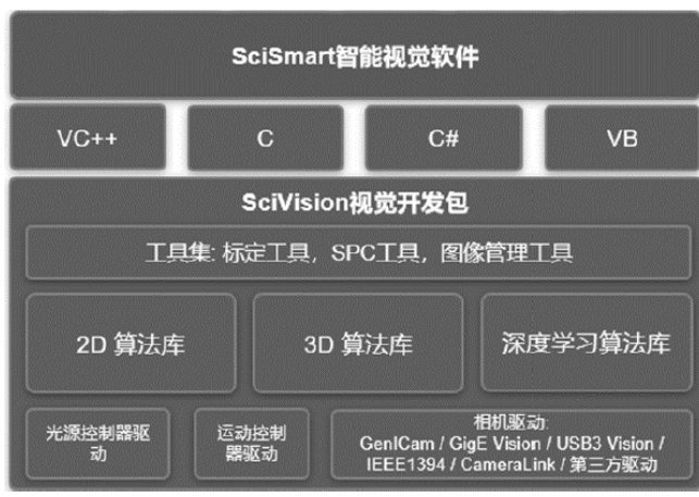
图 8: 公司视觉处理分析软件架构
