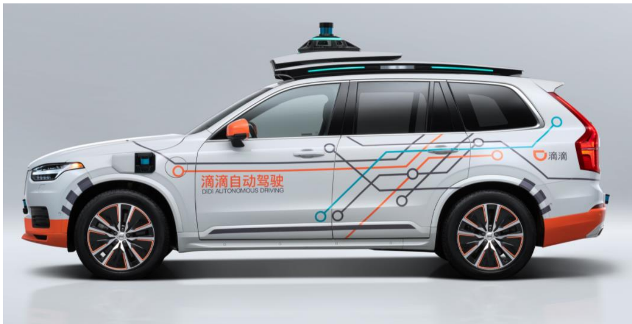
图：配备滴滴双子星（Gemini）自动驾驶硬件平台的沃尔沃XC90
