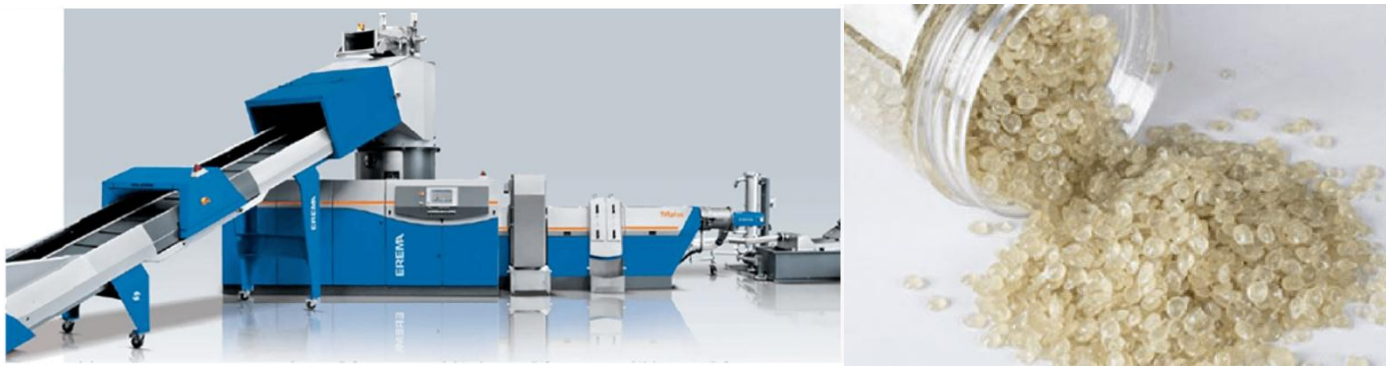
图 30：公司造粒系统及 PS 塑料粒子成品
