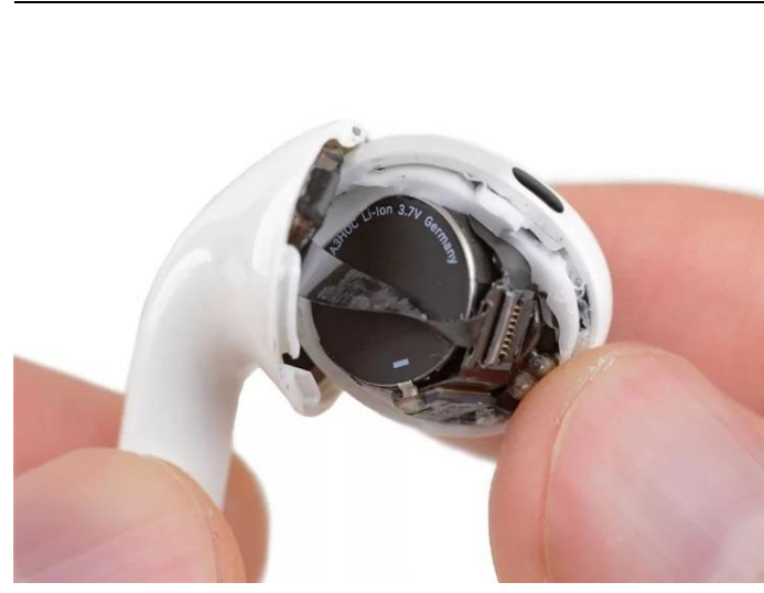
图32: AirPods Pro 搭载 Varta 的扣式电池
