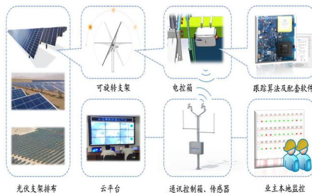
图 表 9 跟踪支架系统示意图
