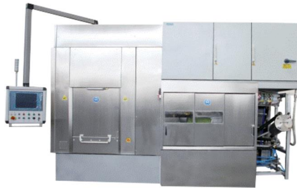
图 52：公司自主研发的 WSK900B 切片机，目前量产切割 210 硅片的良率已达 95%
