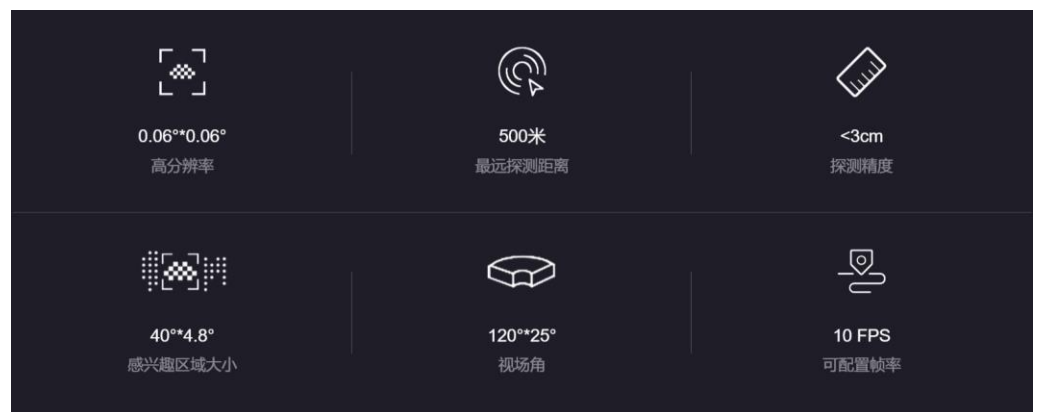
图 11：图达通高精度激光雷达主要参数
