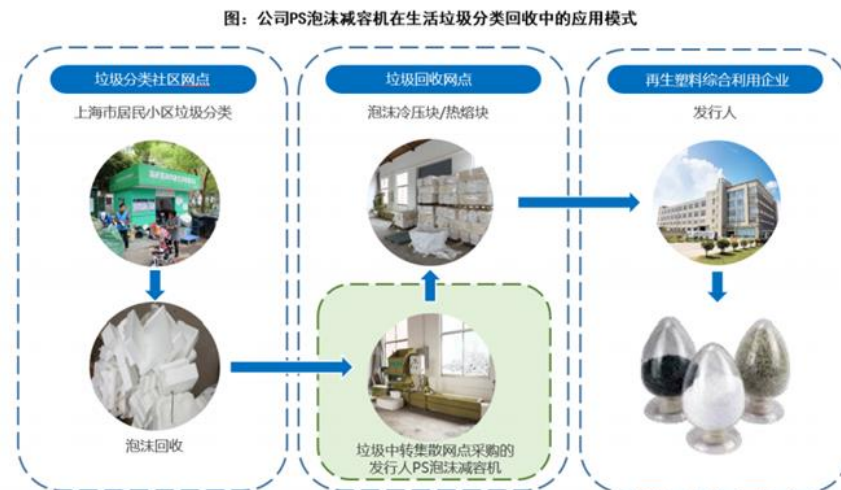
图 28：公司的 PS 泡沫减容机的应用模式
