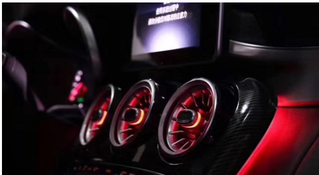
图 26: 内置 LED 灯带空调出风口
