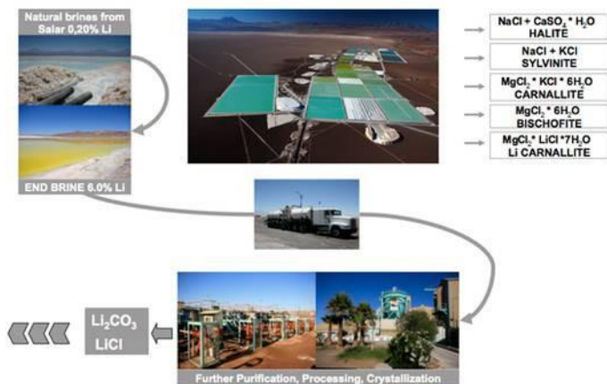
图表 103: 雅保将卤水富集后运至 La Negra 工厂进行进一步加工
