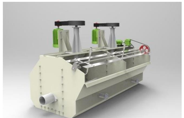
图表 64: 矿石浮选设备，主要用于细粒嵌布的锂云母矿开采
