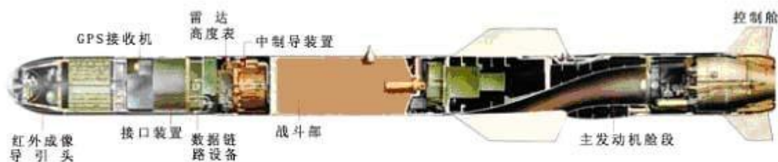
图 23 “斯拉姆”block1e/agm-84e 对陆攻击导弹结构
