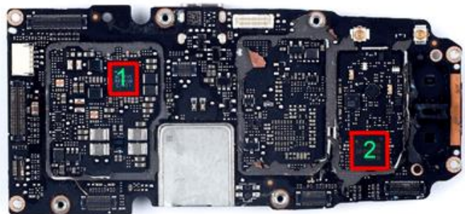
图表 17 大疆创新 Mavic Air 2 主控主板背面主要 IC
