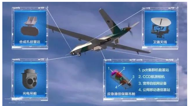
图表 6 翼龙-2H 吊舱给通信载核的空间和重量配额有限
