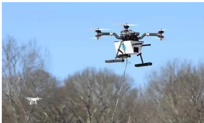
图表 5 系留式无人机通过有线回传数据或提供电力
