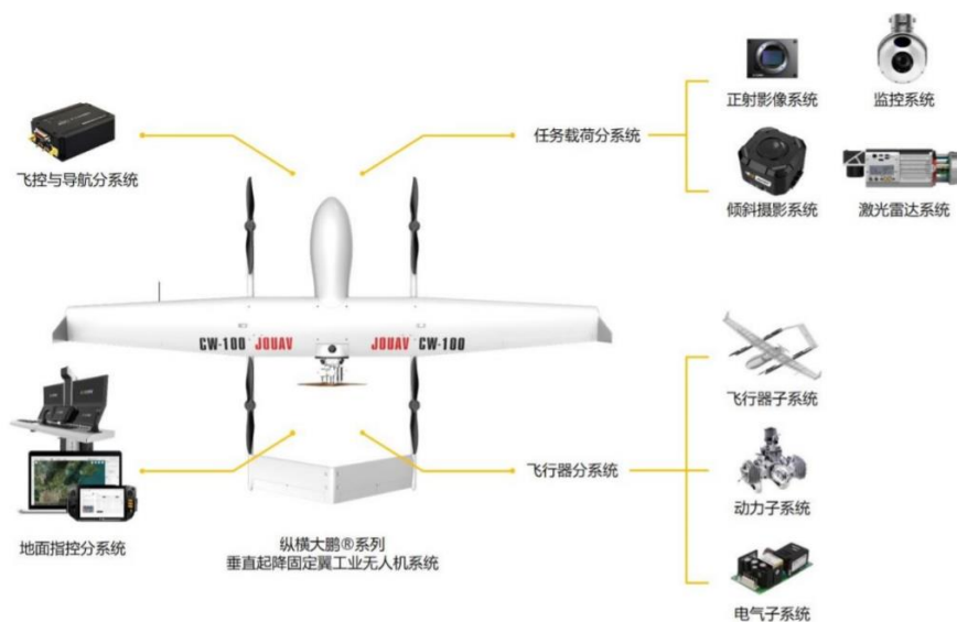
图表 8 无人机系统构成：飞行器平台、飞控与导航、任务载核和地面指控
