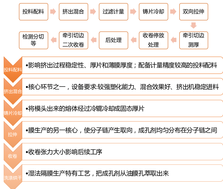
图 83：湿法隔膜工艺流程
