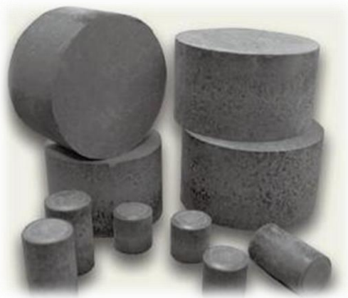
图 24: 环氧塑封料实物图
