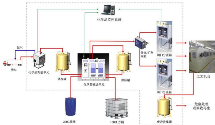
图 27：化学品供应系统工作原理
