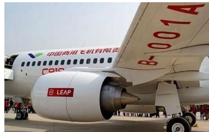
图17：C919型客机配置LEAP1-C型发动机
