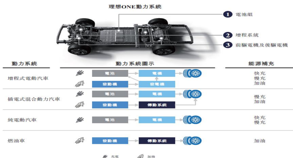
图表10 理想 ONE 增程式动力系统，增程式动力系统与其他动力系统的比较
