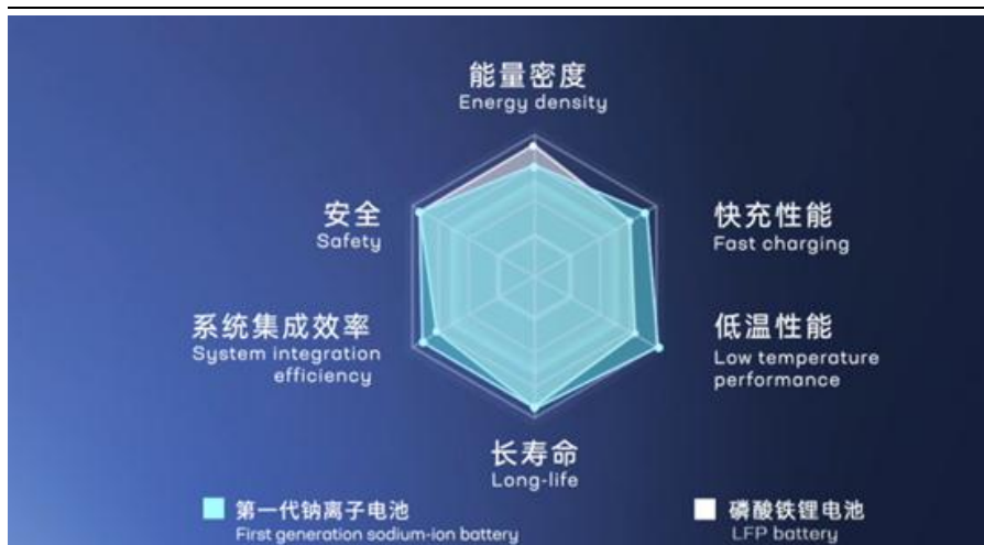
图 6：宁德时代第一代钠离子电池与磷酸铁锂电池比较
