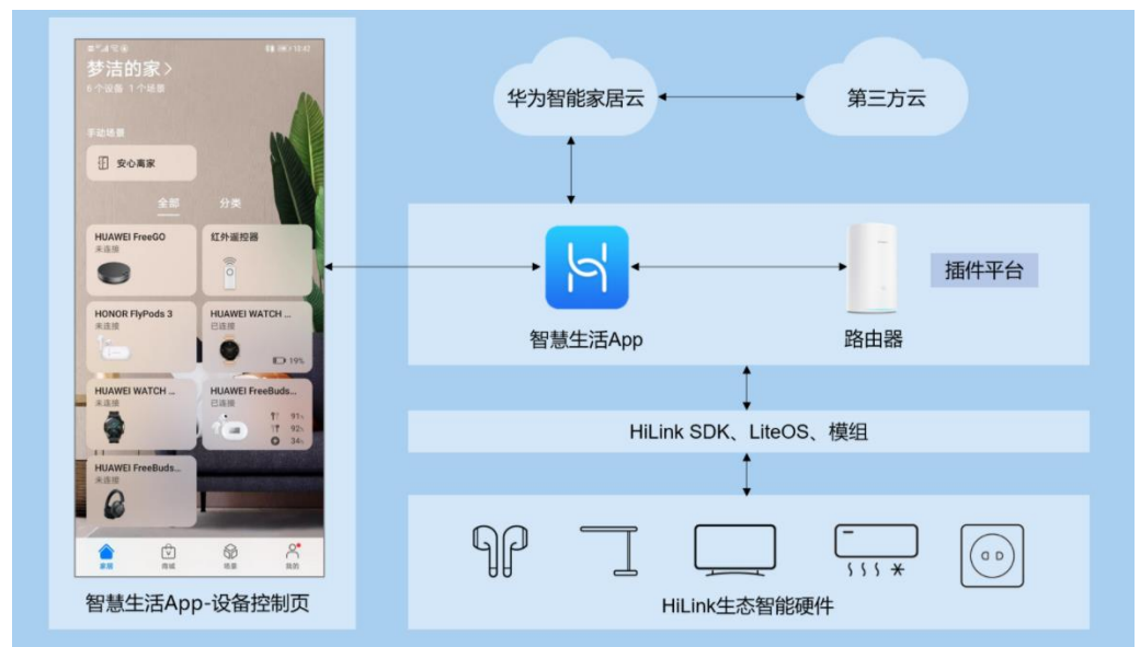
图表 29: 华为 HiLink 平台连接架构
