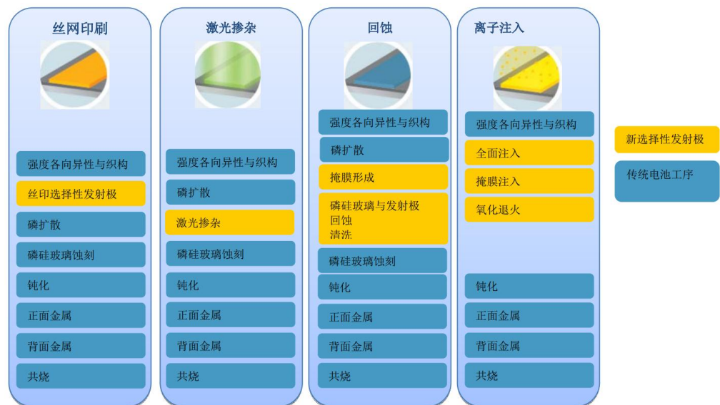
图 7：选择性发射极制造方法
