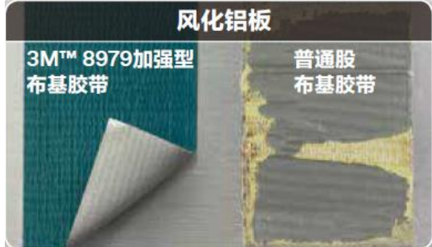
图 69：3M 布基胶带与普通布基胶带耐风化性对比
