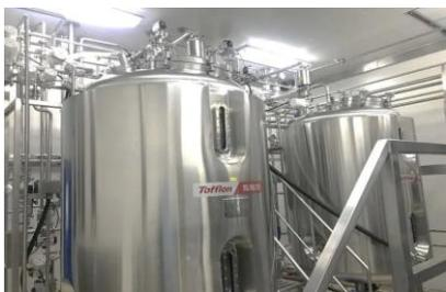
整合了洁净室行车系统，通过扫描贴于固体物料袋上的二维码，能够实现自动投料和自动溶液配制输送，避免过程中人员的误操作和投料信息的缺失。
