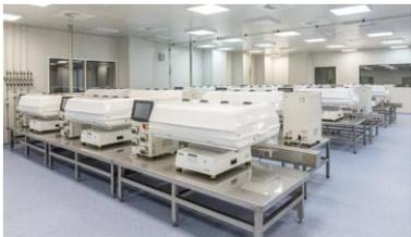
可以满足从毫升规模到百升规模物料的生产。可以很方便地实现小批量多品种产品的快速生产；相较于一次性反应器，CES 系统的生产成本更低，操作更加灵活；东富龙耗材公司生产的一次性扩增袋整合了 pH，DO 等电极，可以方便的进行过程监控。
