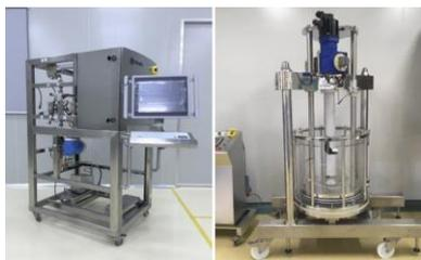
包含深层过滤，超滤，层析等多种设备；在关键部件上定制化开发，已经能够实现百平米及中空纤维超滤系统，和平板膜超滤系统的国产化，并且成功将直径 1.2 米的层析设备推向市场；直径 1.8 米的层析设备在研中
