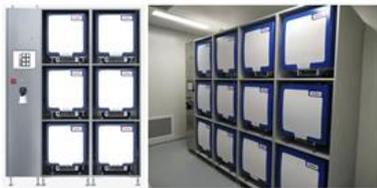
可保证每一个培养箱的工艺参数独立设定，整个气路互不干扰。并且能把整个培养周期的数据实时上传到中央数据中心；在整合 RTP 阀门以后，可以实现全流程的隔离操作。真正实现对人员的全方位保护
