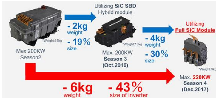
图32: Rohm 的 SiC 功率模块使得逆变器的尺寸和重量大大减少
