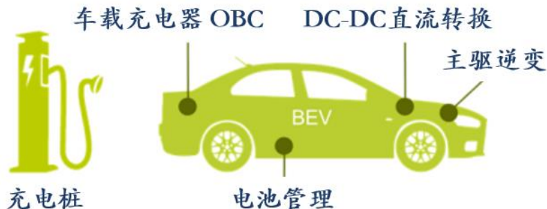
图8: IGBT 主要在新能源汽车的高压领域进行应用
