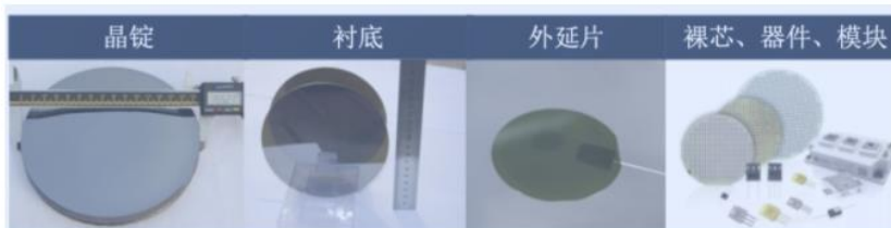
图38: 第三代半导体制造流程总体与硅基半导体类似
