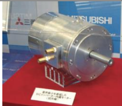
图35: 三菱电机实现了逆变器与电机的一体化
