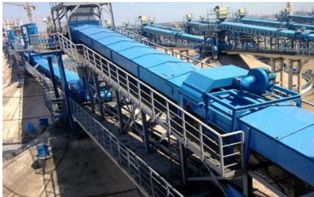
图 33：铝合金气垫式连续热处理炉实物图
