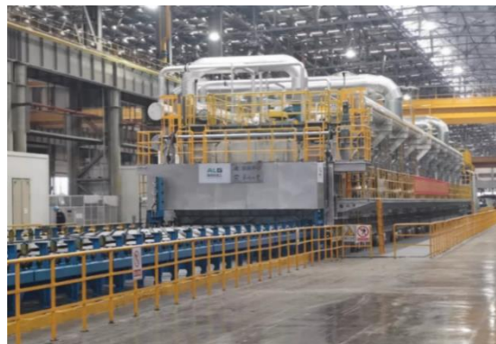
图 47：铝合金中厚板辊底式固溶热处理炉实物图
