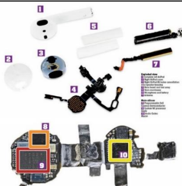
图表 34: AirPods 耳机拆解
