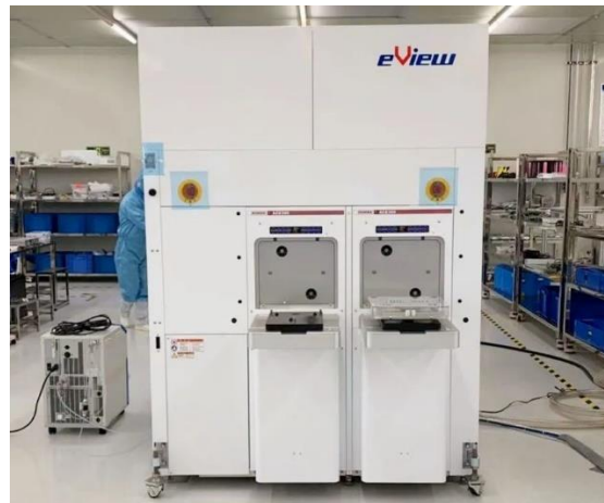
图表 19: 公司电子束检测设备 eView™ 全自动晶圆缺陷复查设备
