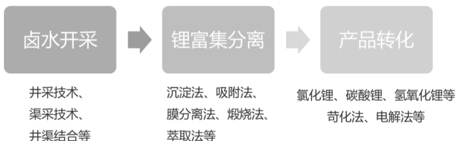
图 12：盐湖提锂工艺流程
